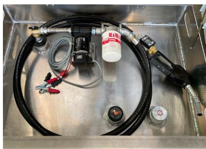
particolare gruppo pompa particular pump group
