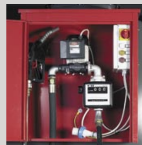
LCI Particolare quadro elettrico con indicatore di livello. Segnalatore di "serbatoio in riserva", display a cristalli liquidi, visualizzazione in litri del contenuto del serbatoio. Precisione ± 1%.
